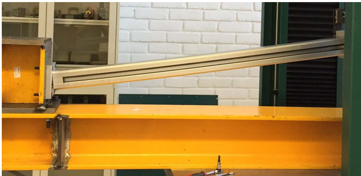
Foto 2. Oppsett for prøving av stivhet og styrke for toppmonterte rekkverksstolper
