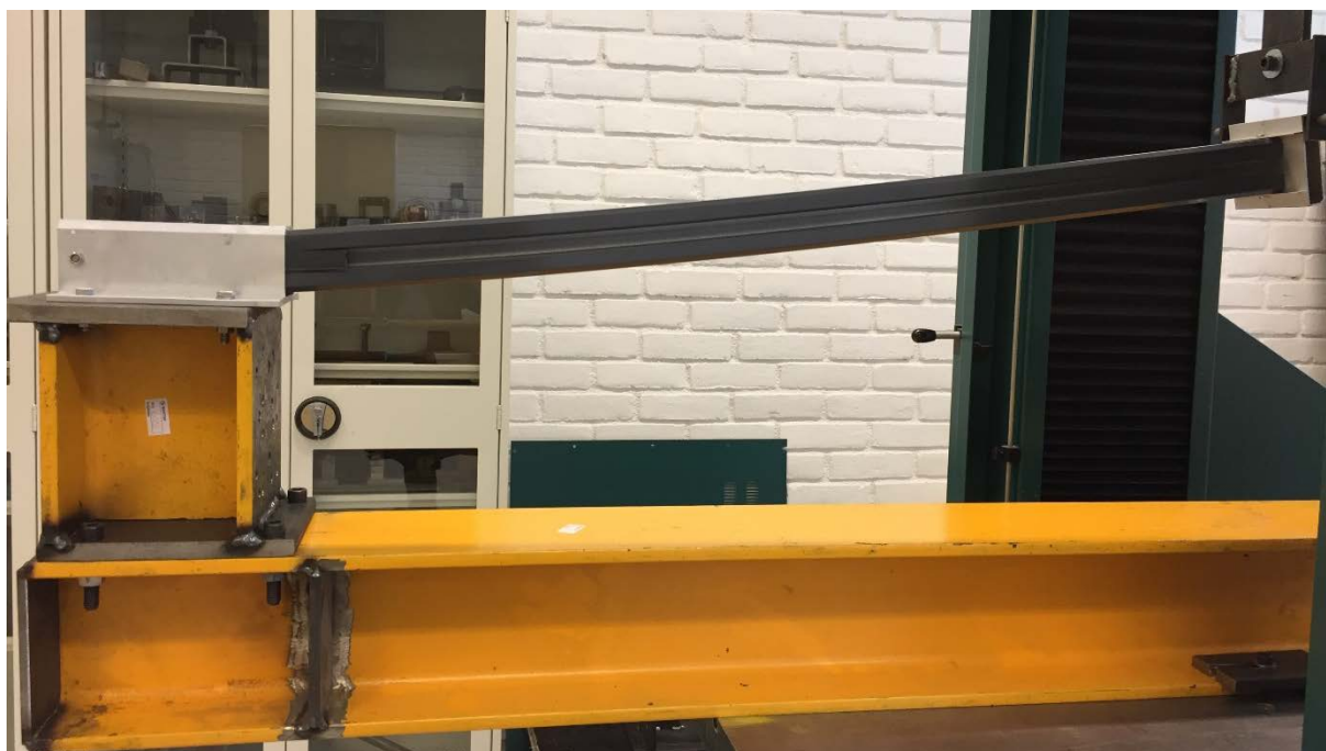
Foto 3. Oppsett for prøving av stivhet og styrke for dekkeforkantmonterte rekkverksstolper
